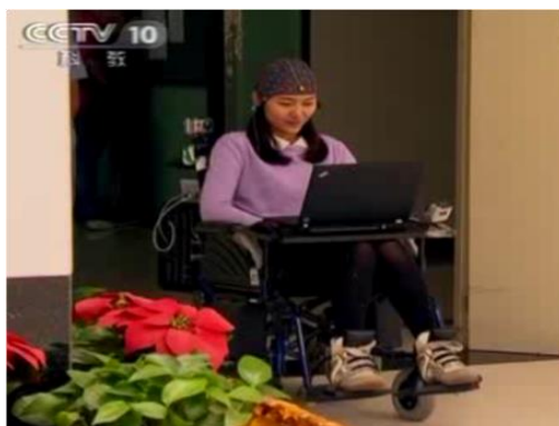
图 2 面向中风康复的脑控轮椅(央视科教频道 2013)
