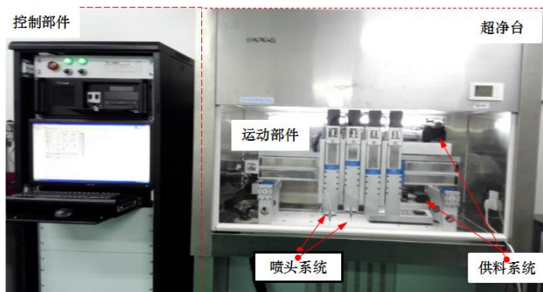
图 9-1 自制多喷头生物 3D 打印设备
