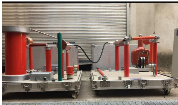
图 1 振荡型操作冲击耐压试验设备实物
