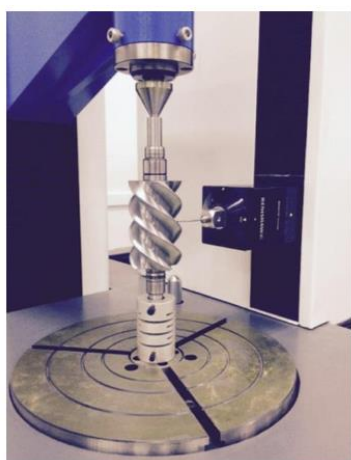
图 5-3 阳极转子检测实例及测量报告
