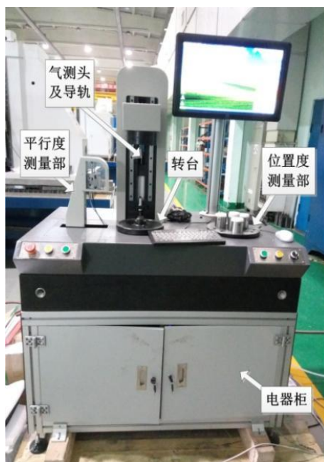
图1 零件多几何要素在线快速检测仪
