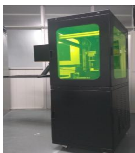
图 4-1 陶瓷光固化面成形自制设备
