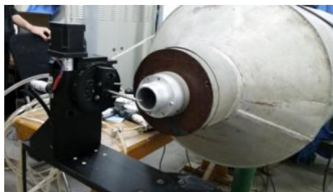
图 4 探针自动校准机构及风洞
